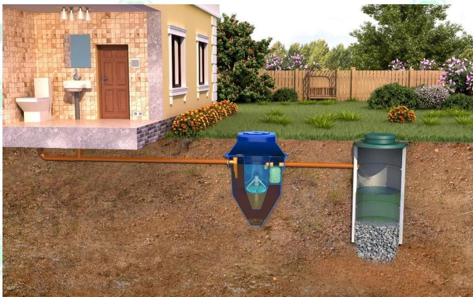
**Рисунок 7. Монтаж с отводом очищенных сточных вод в фильтрующий колодец. Подходит для хорошо поглощающих грунтов (песок, супесь) и низком уровне грунтовых вод**
