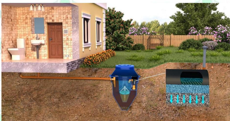
**Рисунок 6. Монтаж с принудительным отводом сточных вод в дренажный элемент.**
