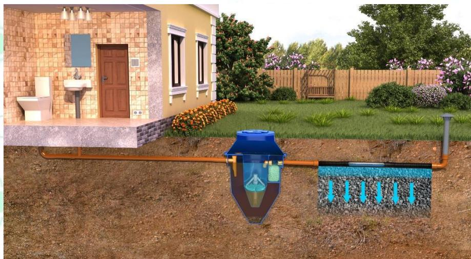
Рисунок 4. Монтаж ALFA<sup>БИО</sup> 0.8 с самотечным отводом очищенных сточных вод в дренажную траншею.
