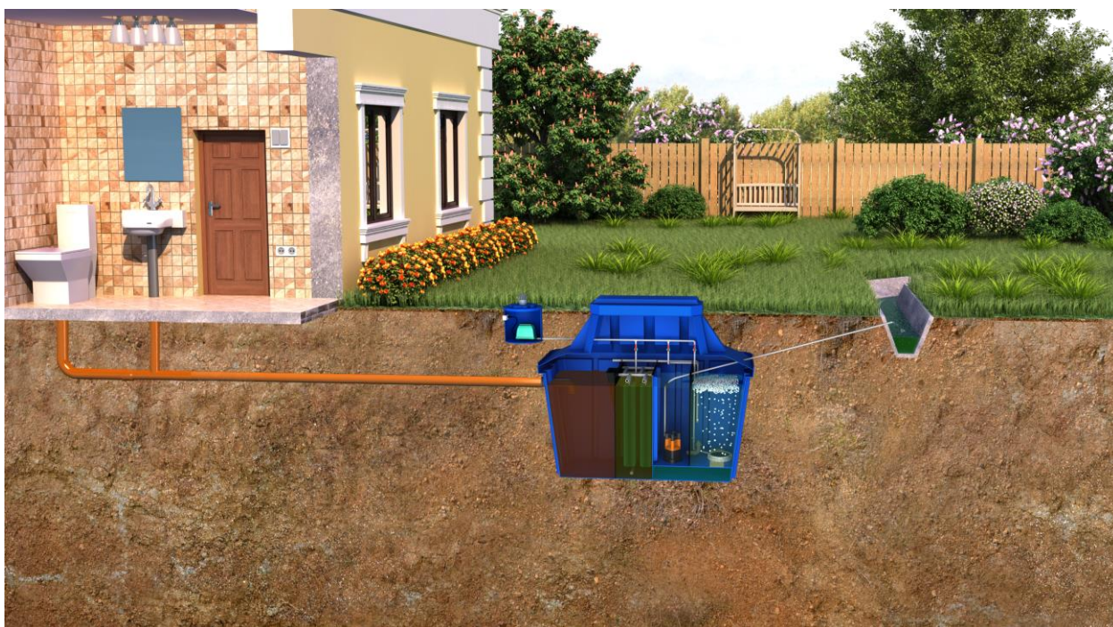
Рисунок 4. Монтаж ALFA GEO с принудительным отводом очищенных сточных вод в ливневую канаву
