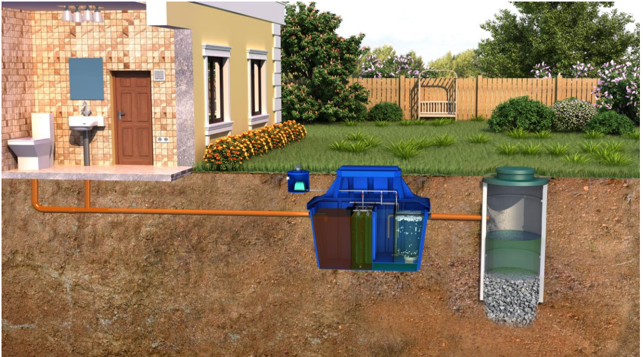
Рисунок 5. Монтаж ALFA GEO с самотечным отводом очищенных сточных вод в дренажный колодец из бетонных колец
