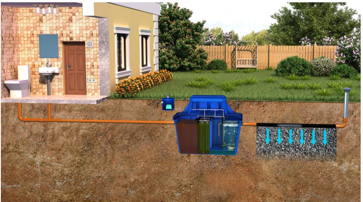
Рисунок 6. Монтаж ALFA GEO с самотечным отводом очищенных сточных вод в дренажную траншею из перфорированной дренажной трубы и щебневой отсыпки.
